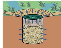
Figura 3-XIII: Esquema-tipo de poço de infiltração
