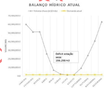
Figura 16: Balanço hídrico do cenário atual, em linha, o volume de escoamento da chuva e em amarelo a demanda ao longo do ano, para o cenário atual).
